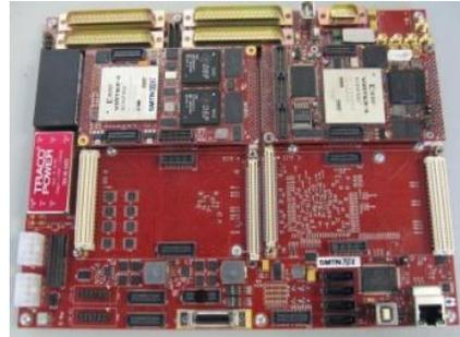
サンダンス製の組み立てユニットと拡張性のある多重処理コンセプトで構成された DVIP プラットホームは、2 個の TI C6455 デジタル信号プロセッサと DM642 DSP ベースのデジタル・メディアプロセッサの性能と柔軟性を利用してしています。
