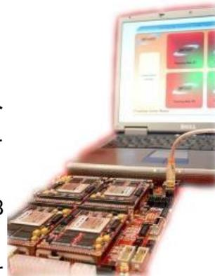
RASS はさまざまな通信インターフェースに適應できるプラットフォームです。USB、Gigabit イーサネット、SATA、ファイバーワイヤ、RS-485、RS-232、および LVDS I/O が準備されております。補助的な Xilinx Virtex-4 FX60 FPGA は 2 つのパワーPC コントローラコアを含んでおり、主になる Virtex-5 ノードをフリーにしてコプロセッサが迅速に処理をしております。
